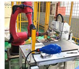
机械手用于金属埋入成型
