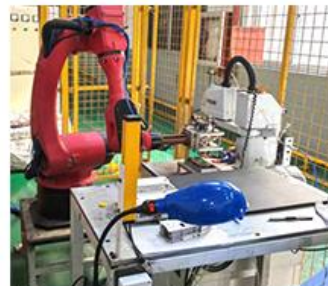
机械手用于金属埋入成型
